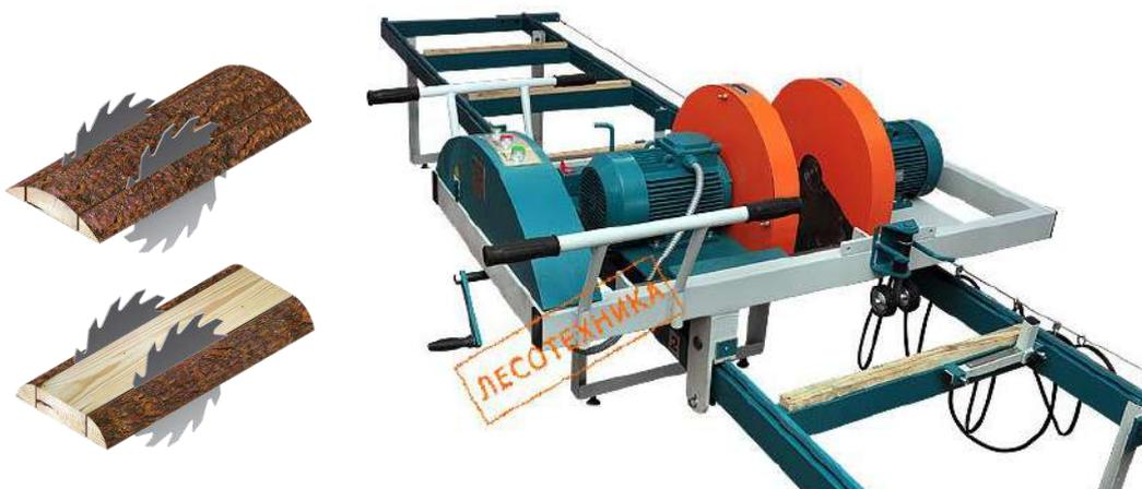
Станок **ЦОД-450** предназначен для обрезания кромок и раскря необрезной доски с целью получения обрезного пиломатериала, а также для двухсторонней откромковки горбыльной доски с целью дальнейшей её переработки в обрезной пиломатериал на горбыльно-ребровом станке типа ГР-500. Другое применение станка не рекомендуется.
